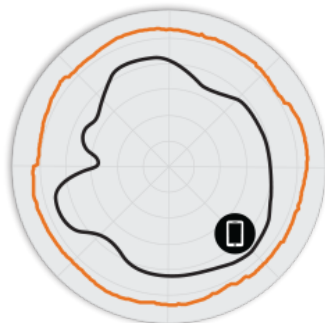
РИСУНОК 3 Азимутальная плоскость 5 ГГц R720 Диаграммы направленности антенны
