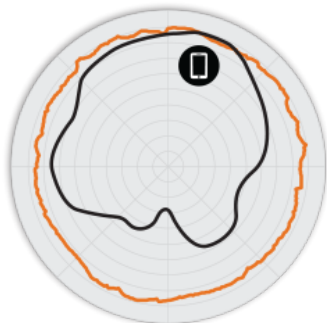
РИСУНОК 2 Азимутальная плоскость 2,4 ГГц R720 Диаграммы направленности антенны
