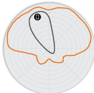
РИСУНОК 4 Вертикальная плоскость 2,4 ГГц R720 Диаграммы направленности антенны
